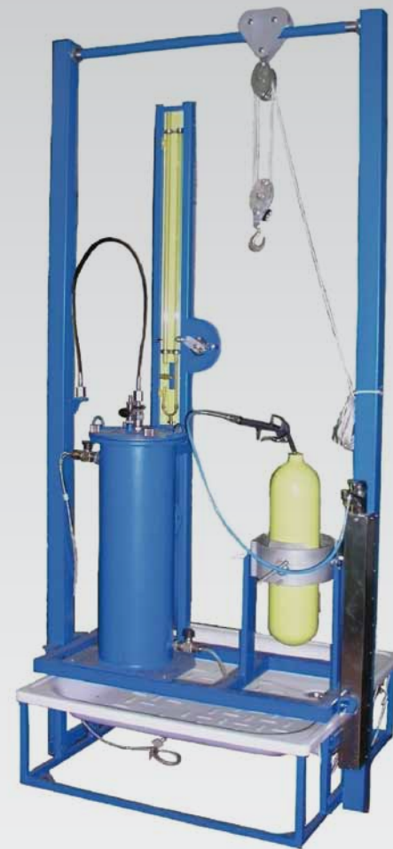
Стенд для переосвидетельствования баллонов методом объемного расширения
