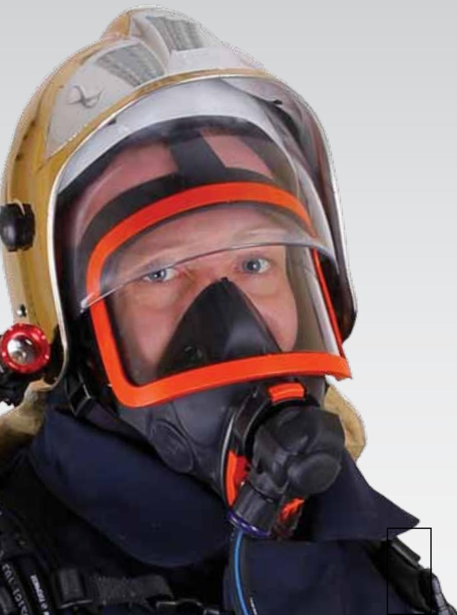
Панорамные маски имеют сменные ударопрочные поликарбонатные стекла, снабжены металлическими переговорными мембранами и удобными регулировочными замками крепления оголовья. Обладают повышенной теплостойкостью, в частности, выдерживают воздействие открытого пламени в течение 5 секунд и теплового потока  $8,5 \text{ кВт/м}^2$  в течение 20 минут. В панорамные маски можно установить гарнитуру связи.
