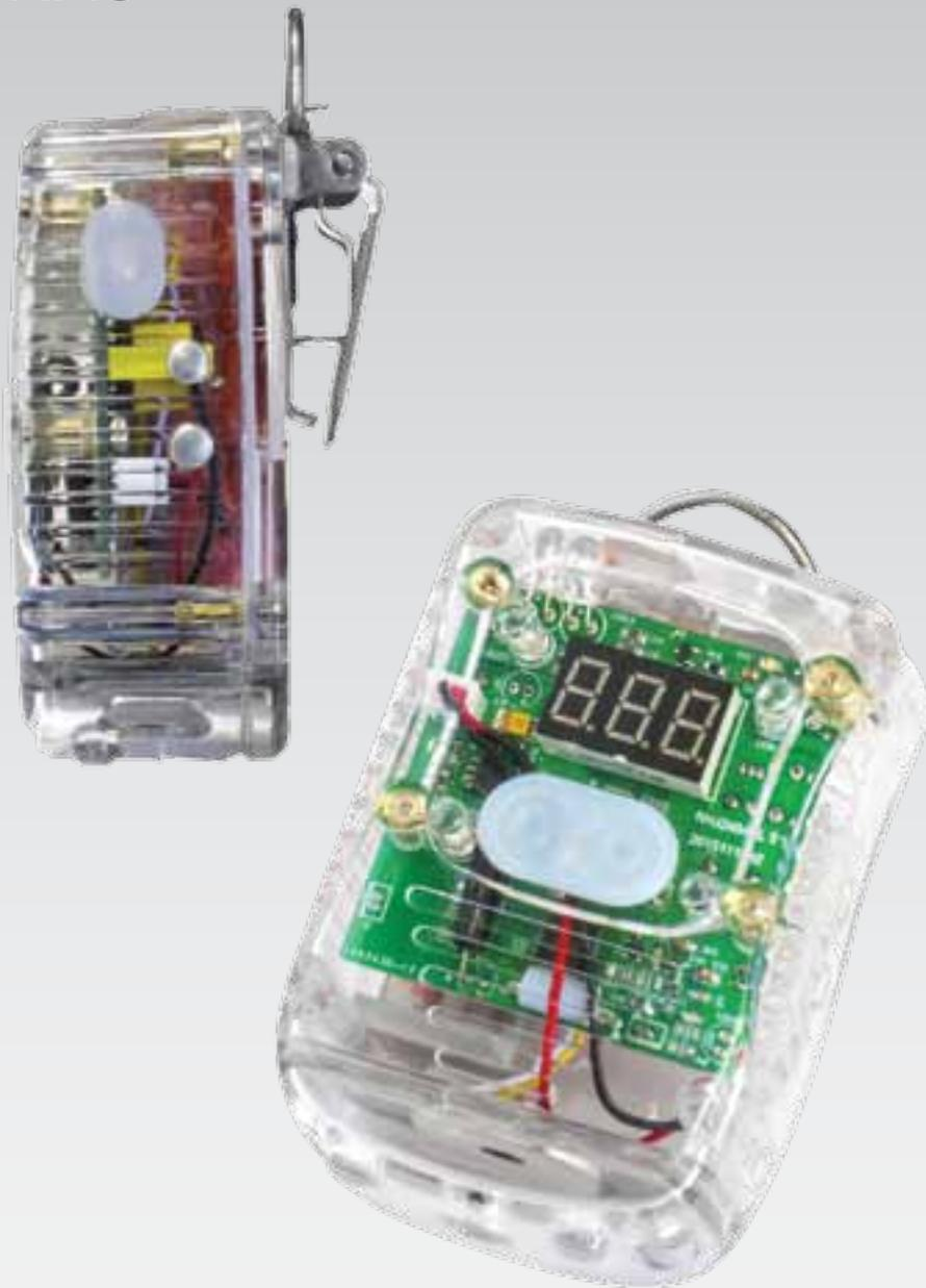
Система оповещения «ПАС», производства компании АО «Дыхательные системы-2000» предназначена для использования сотрудниками ФПС и аварийно-спасательными формированиями для обнаружения человека, находящегося в неподвижном состоянии на задымленной территории или в темноте.
