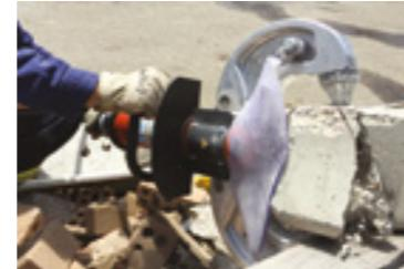
В паре с бетоноломом рекомендуется применять минирезак CU 4007 С или SMC 5006.
