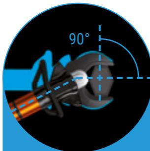
Наклоненные лезвия сохраняют идеальный угол 90°, необходимый для эффективной резки. Любое другое положение снижает производительность резки.
